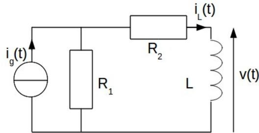
**(A)** La source de courant  $i_g(t)$  en parallèle avec la résistance  $R_1$  peut être remplacée par une source de tension  $e_g(t) = R_1 \cdot i_g(t)$  en série avec la résistance  $R_1$ .
