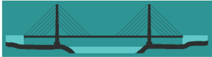
(E) Sur un ouvrage haubané comme celui qui est décrit à l'item précédent, sous l'effet du seul poids propre (en l'absence de circulation, de vent, de variations de température), le tablier est sollicité en flexion simple.
